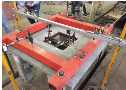
Hình 5: Sơ đồ bố trí dụng cụ đo
